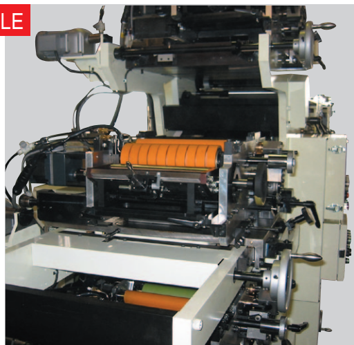
シール印刷機8色機取付例
