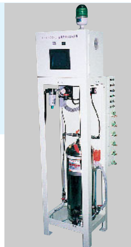
タッチパネル方式6色機用制御板と溶剤タンク
